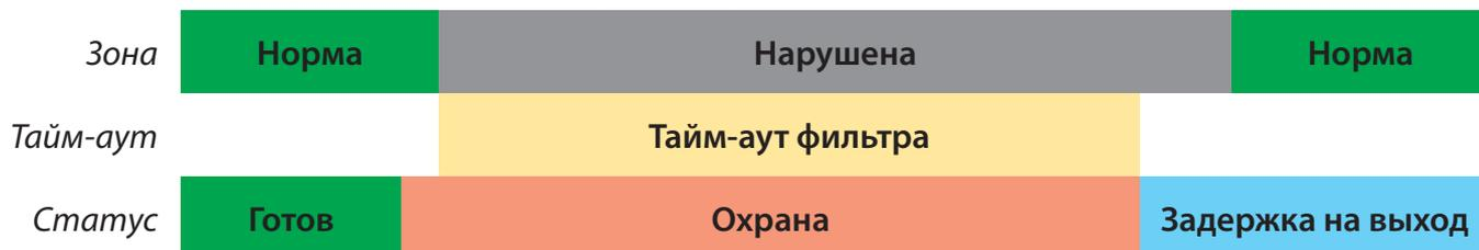
*Начало задержки на вход по окончании тайм-аута после нарушении зоны Вход-выход.*
