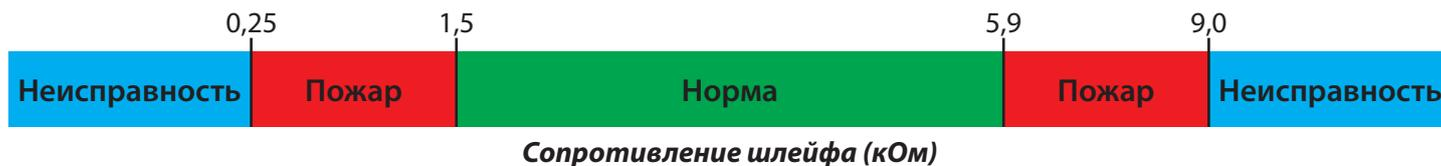
Сработал любой извещатель в течение 2 с - ППКОПУ перейдет в режим ВНИМАНИЕ, далее выключение питания в шлейфе на 3 с, включение питания шлейфа и пауза после включения 2 с. Если в течение минуты зафиксирована сработка любого извещателя на 2 с - переход в режим ПОЖАР, если в течение минуты ни один извещатель не сработал, возврат в дежурный режим работы.
