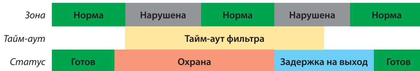
**Начало задержки на вход при втором нарушении зоны Вход-выход.**
