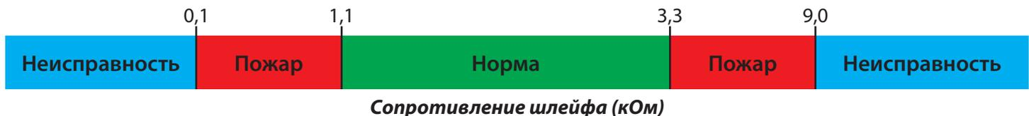
При настройке входа в NV Pro выбрать тип зоны Пожарная (4х-проводный извещатель), при этом требуется установить оконечный резистор номиналом 2.2 кОм.
